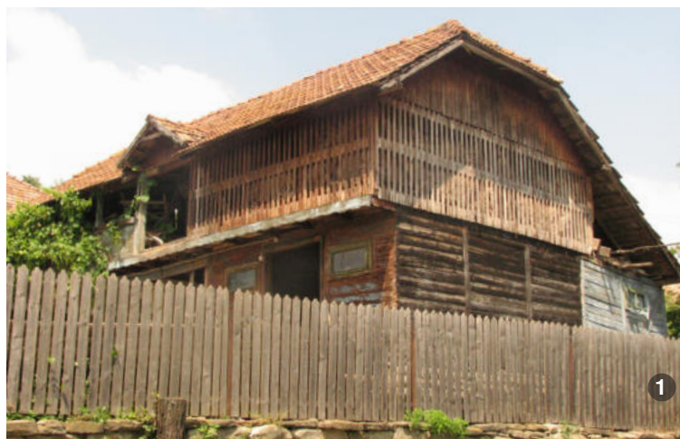
Anexă construită din lemn, al cărei volum poate cuprinde spații utile atât unei locuințe cât și unor funcțiuni complexe, cum ar fi pensiuni. Grijă cu care este prelucrat lemnul o încadrează în categoria exemplarelor de urmat în realizarea închiderilor exterioare.
