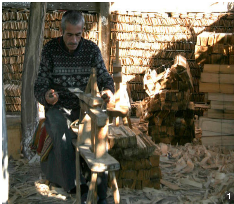
Unelte tradiționale pentru realizarea șindrilăi.
